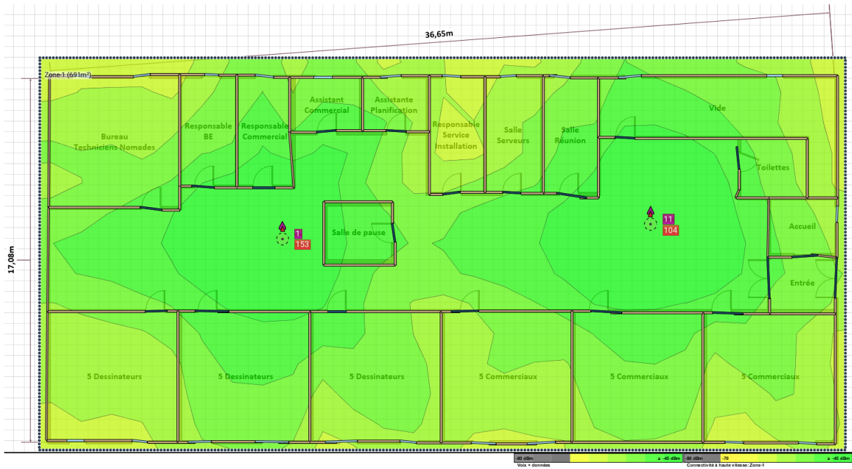
Figure 24 - Cartographie Wi-Fi des bureaux d'Annecy
