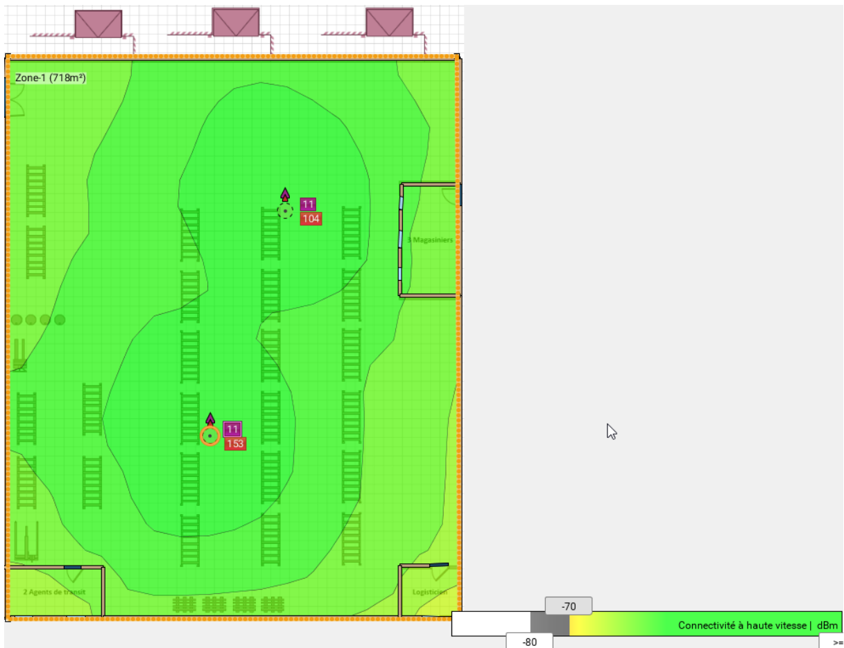
Figure 22 - Cartographie Wi-Fi de l'entrepôt de Dax
