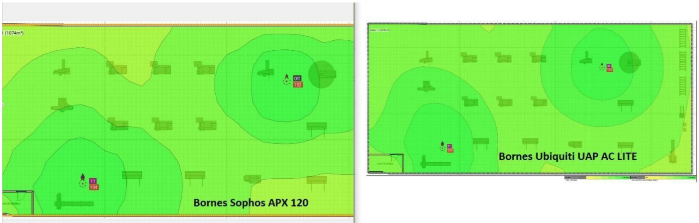
Figure 15 - Comparaisons de couverture Wi-Fi entre une Borne Sophos et une borne Ubiquiti
